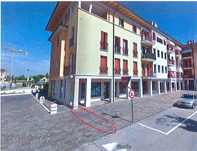
In corrispondenza del punto evidenziato in Foto 5, rileviamo il punto di separazione tra le varie zone del garage interrato. Come espresso dalle foto effettuate in sede di sopralluogo, sono evidenti segni di infiltrazione proprio nel punto di separazione tra i due corpi di fabbrica. In questo caso sembra evidente che la guaina a protezione del giunto di dilatazione, nel tempo si sia danneggiata portando ad infiltrazioni nei punti di separazione tra i vani Garage.
