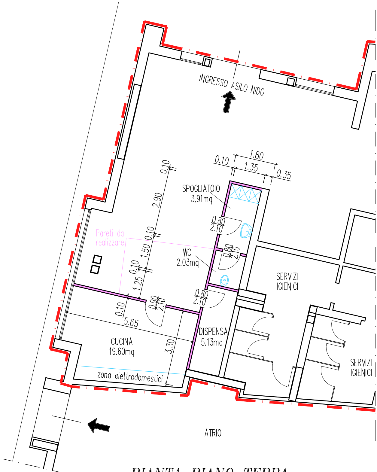
PIANTA PIANO TERRA (particolare pareti divisorie) scala 1:100
